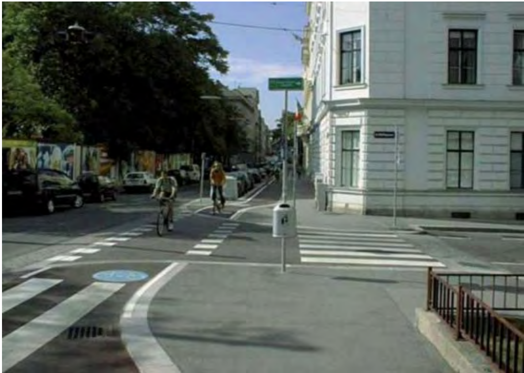
Abbildung 58: Best Practice Beispiel für eine optimale Bodenmarkierungs-Lösung im Bereich von Knotenpunkten: Von der Fahrbahn nicht abgesetzte Radfahrerüberfahrt (Quelle: FSV 2014)
