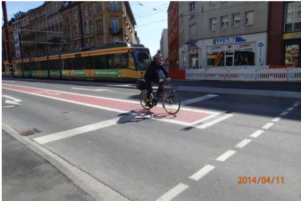
Abbildung 57: Best Practice Beispiel für eine optimale Bodenmarkierungs-Lösung im Bereich von Knotenpunkten: Vorgezogene und farblich hervorgehobene Aufstellfläche für Radfahrer vor Kreuzung (Quelle: verkehrplus -Karlsruhe)
