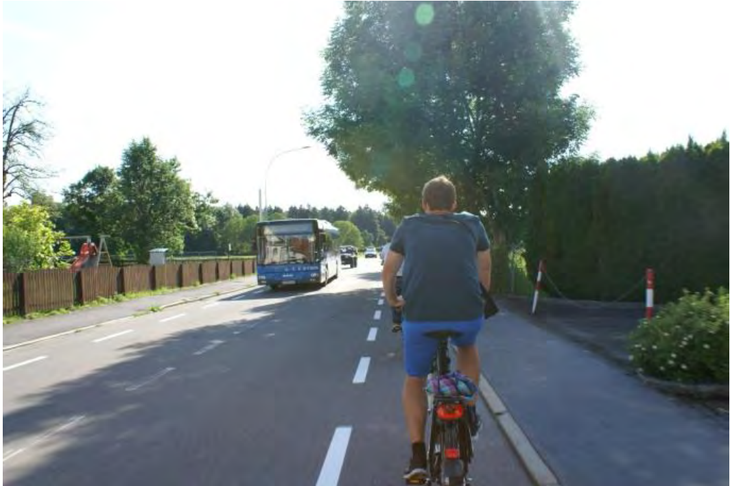
Abbildung 60: Best Practice Beispiel für eine optimale Bodenmarkierungs-Lösung abseits von Knotenpunkten: Einfacher Mehrzweckstreifen (Quelle: verkehrplus - Bregenz)
